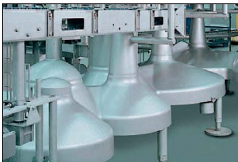
Příklad řešení hygienického designu plniče (Zdroj: www.khs-ag.com)
